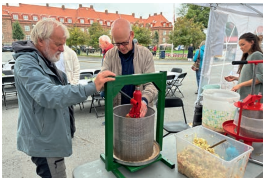
Det var flere eplepresser som frivillige holdt i sving. Den største greide å presse opp mot 60 liter eplemost i timen.
